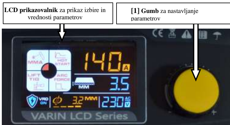
Slika 1: Čelna plošča varilnega aparata
