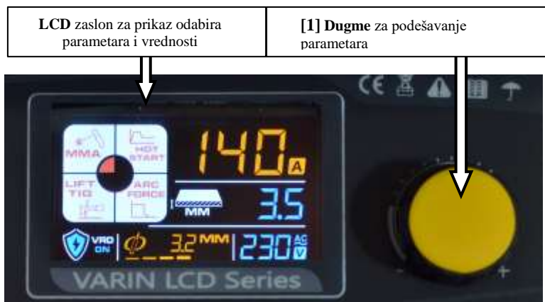
Slika 1: Čeona ploča aparata za zavarivanje
