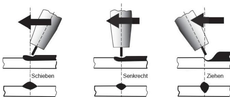
Die Schweißpistole sollte in einem Winkel zur Schweißnaht gehalten werden. (Halten Sie die Pistole so, dass Sie die Schweißnaht jederzeit sehen können. Tragen Sie immer einen Schweißhelm mit geeigneten Filtergläsern und verwenden Sie die richtige Sicherheitsausrüstung.
