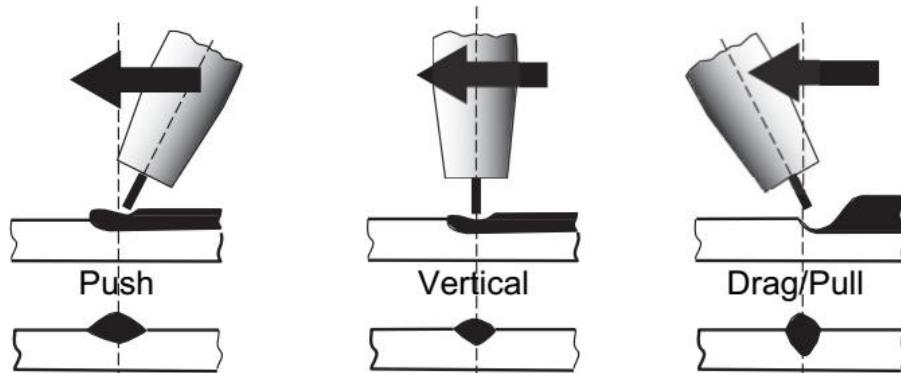
Varilno pištolo je treba držati pod kotom varilnega spoja. (Glejte spodaj spremenljivke sekundarne nastavitev) Držite pištolo tako, da je talina ves čas pregledna. Varilno čelado vedno nosite z ustreznimi filtrirnimi lečami in uporabljajte ustrezno varnostno opremo.
