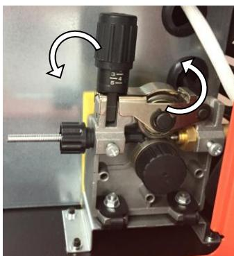
Prüfen Sie, ob die Rille der Drahtförderrolle (21) mit dem gewählten MIG-Drahttyp und dem Drahtdurchmesser übereinstimmt. Die Drahtförderrolle hat zwei unterschiedlich große Rillen. Die Größe der verwendeten Rille ist auf der Seite der Drahtförderrolle eingeprägt. Für weichen Fülldraht, wie er beim gaslosen MIG-Schweißen verwendet wird, hat die Rille der Antriebsrolle einen gezackten Rand. Bei "hartem" MIG-Draht hat die Rille der Antriebsrolle ein "V"-förmiges Profil.
