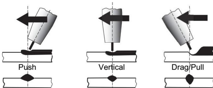
Svařovací hořák musí být držen pod úhlem směrem k svarovému spoji. (viz Proměnné sekundární nastavení níže) Držte hořák tak, aby tavenina byla vždy průhledná. Vždy používejte svářečskou kuklu s vhodným filtrem a používejte vhodné bezpečnostní vybavení.
