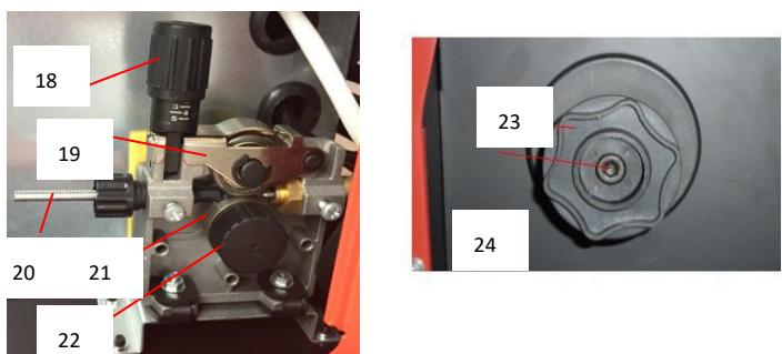
18. Nastavení napnutí drátu
