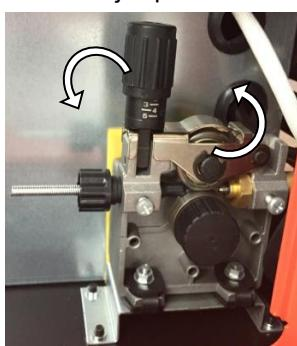
5.1.2.2 Zkontrolujte, zda drážka podávací kladky (21) odpovídá zvolené tloušťce svařovacího drátu. Podávací kladka má dvě různě velké drážky, velikost použité drážky je vyražena na straně podávací kladky. U "měkkého" trubičkového drátu, který se používá při bezplynovém svařování MIG, je drážka podávací kladky ozubená. U "tvrdého" drátu by drážka kladky měla mít profil "V".
